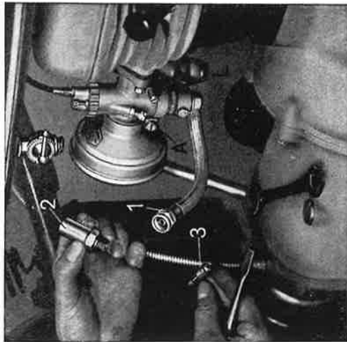
Afb. 12. Het schoonmaken van de benzinekraan
