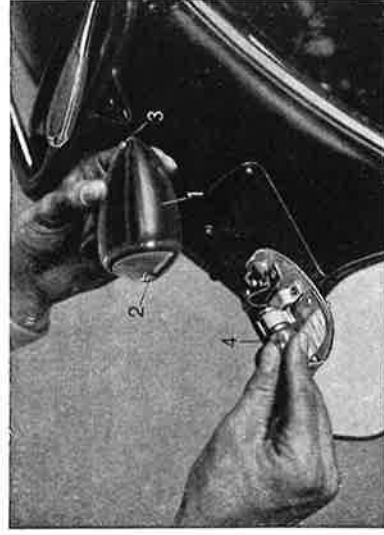
Afb. 56. Het monteren van de gloeilamp in de achterlamp
