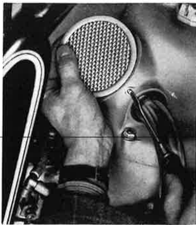
Afb. 42. Het uitnemen van de luchtfilter. modellen 51/61/66/71
